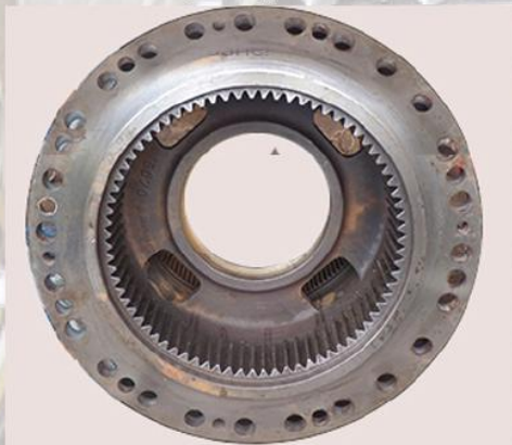
9.3 Vành răng hộp giảm tốc Máy đập đá vôi
