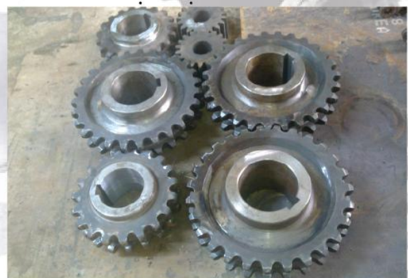
7.2 bánh xích máy cấp than Nhiệt điện Cẩm Phả
