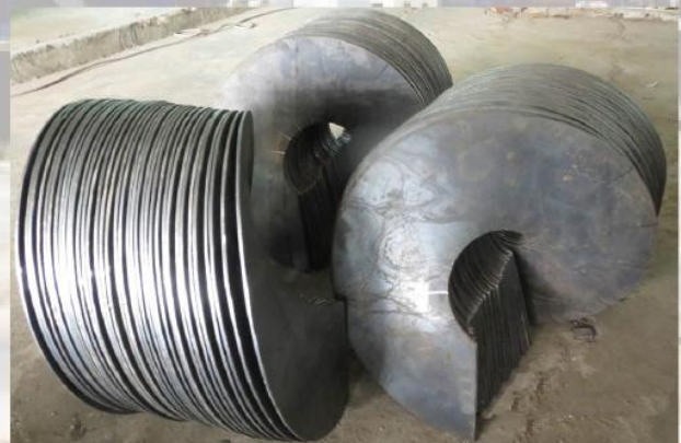
8.5 Chế tạo cánh xoắn vít tải (vật liệu hardox 500)
