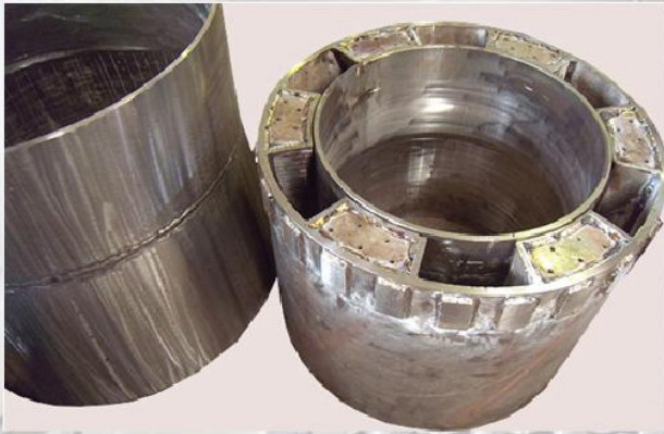
9.3 Vành răng hộp giảm tốc Máy đập đá vôi
